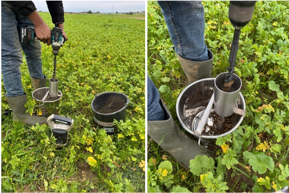
Abbildung 16: Technische Ausstattung (links) und Darstellung des Ziehens von Bodenproben (rechts) auf den landwirtschaftlichen Flächen.
