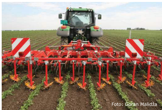
Slika 1. Međuredni kultivator sa rotirajućim zvezdama
