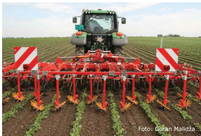
Slika 1. Međuredni kultivator sa rotirajućim zvezdama
