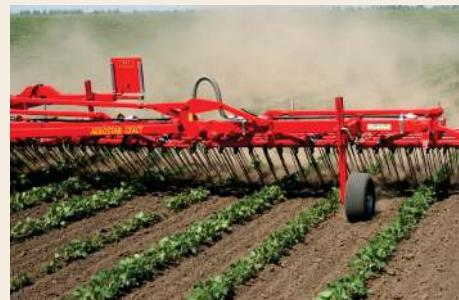
Tlo bez žetvenih ostataka i suho do radne dubine opružnih zupci a korov u fazi nicanja optimalni su uvjeti za upotrebu češljaste drljače.
