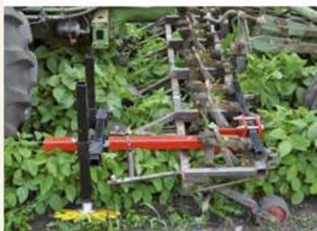
Ротарний культиватор (Rotary hoe) (зверху) особливо ефективний, якщо на поверхні ґрунту утворилася кірка. У старших посівах сої, як правило, використовується комбінація культиватора зі стрільчатими лапами та пальцевої борони (знизу)
