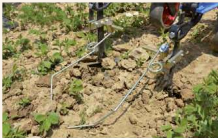
Пружинна борона дозволяє боротись з бур'янами у рядках молодих посівів сої. Для боротьби у міжряддях застосовують мотики
