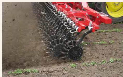
Фрезерні культиватори можуть працювати на високих швидкостях
