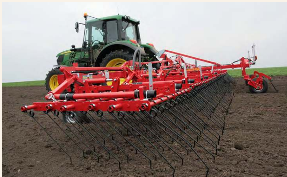
«Сліпе» культивування за допомогою борони з пружинними зубами
