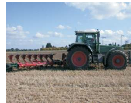
Fig. 19. Aratul solului cu plugul cu cormană și antetrupiță
