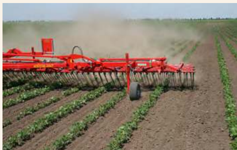
Оптимальні умови: сухий ґрунт, немає решток рослин, чисті зубці
